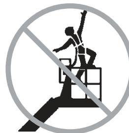
Ne pas s'asseoir, se tenir debout, ni monter sur les rampes de sécurité de la nacelle. Garder constamment les deux pieds fermement posés sur le plancher de la nacelle.
