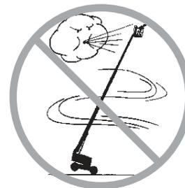
Ne pas relever la flèche lorsque la vitesse du vent peut dépasser 12,5 m/s. Si la vitesse du vent est supérieure à 12,5 m/s lorsque la flèche est relevée, abaisser la flèche et arrêter immédiatement la machine.
