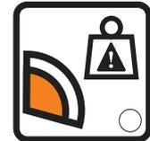
Le témoin allumé indique une amplitude de mouvement limitée en raison du poids de la nacelle.
