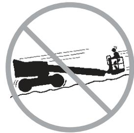
Adapter la vitesse de déplacement en fonction de l'état du sol, de la circulation, de l'inclinaison, de l'emplacement du personnel et de tout autre facteur susceptible de provoquer une collision.
