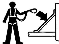
Les occupants de la nacelle doivent porter une sangle ou un harnais de sécurité, conformément aux réglementations officielles en vigueur. Attacher la longe de sécurité au point d'ancrage prévu à cet effet dans la nacelle.
