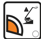
Le témoin allumé indique une amplitude de mouvement limitée en raison du poids de la nacelle et de l'angle de la pente.
