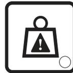
Le témoin clignote pour indiquer que la nacelle est surchargée. Le moteur s'arrête et aucune fonction n'est active.
