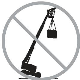
Ne pas placer ni attacher de charges fixes ou suspendues sur une partie de cette machine.
